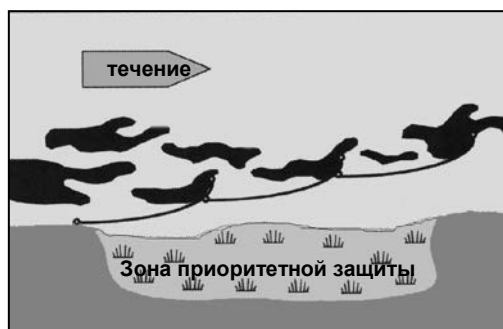
Рисунок 7.7 - Отвод нефтяного пятна бонами, установленными каскадами
