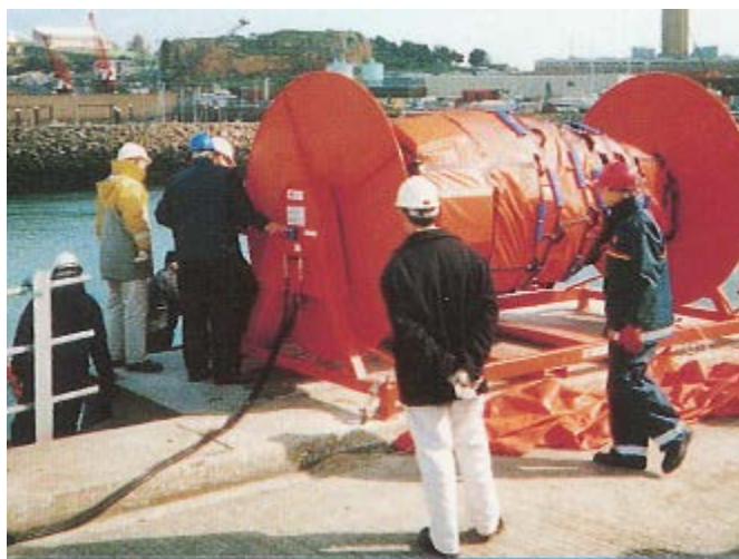
Рисунок Г.2 – Развертывание бонов с причала с использованием гидроприводной катушки
