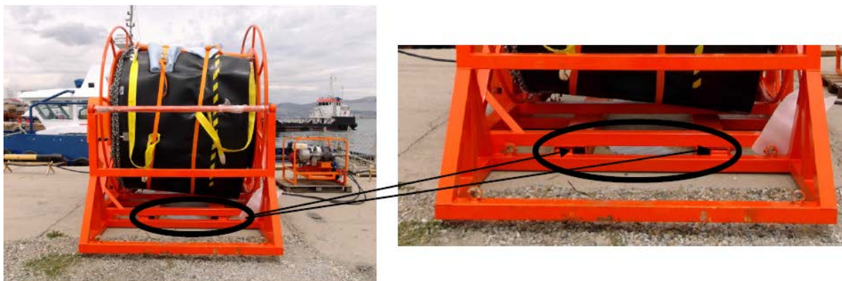
Рисунок Г.4 – Пример крепления рольганга к катушке с боновыми заграждениями
